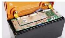
Bei einigen Herstellern lässt sich das Gehäuse öffnen. Unter der Platine sitzen in diesen Fall Rundzellen.
