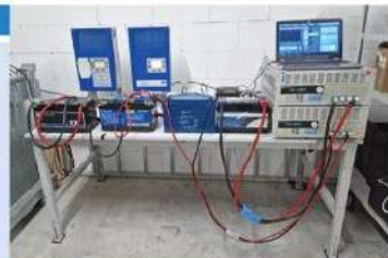
Zwei Ladegeräte (links) füllen die Testakkus mit konstant 50 A Ladestrom. Parallel werden (rechts) zwei Akkus mit bis zu 1100 Watt entladen.
