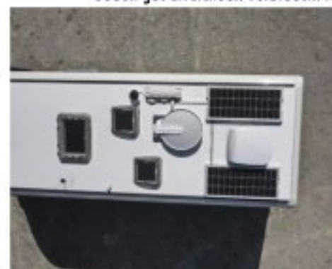
Die zwei Solarpaneele auf dem Dach liefern jeweils 100 Watt Leistung.
