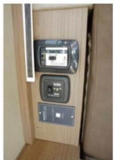
Die Bedienteile des Inverters und Generators neben dem Beifahrersitz.
