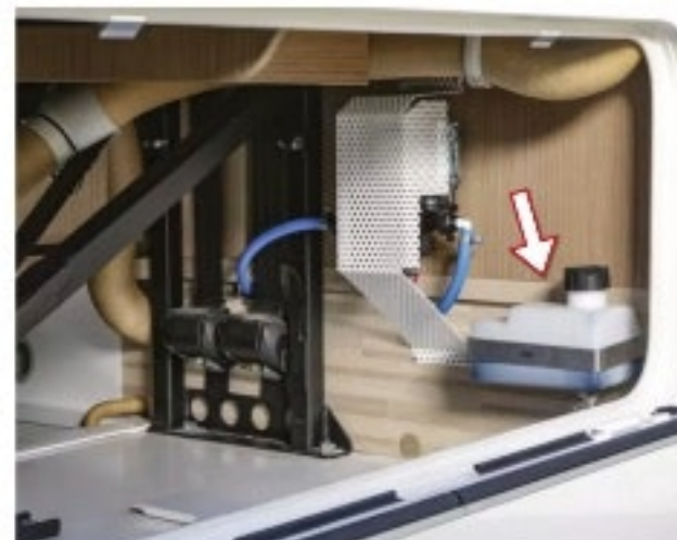
Der Öltank für den Gasgenerator ist im Doppelboden gut erreichbar. Verbrauch: rund 1 l/115 h.
