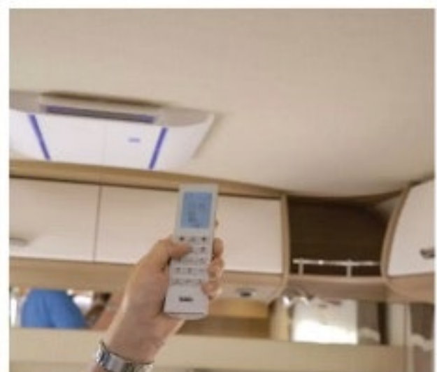
Mit Wechselrichter, Lithiumbatterien, Solarpanelen und Generator kann auch die Klimaanlage autark betrieben werden.
