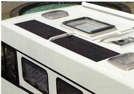
Avec des cellules performantes, les panneaux solaires flexibles sont plus légers que les panneaux rigides.
